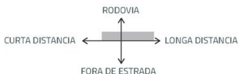
Pneu radial sem câmara desenvolvido para uso em eixos direcionais, livres e de tração moderada de caminhões e ônibus, em rodovias pavimentadas de curta, média e longa distância.
