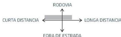
O Firestone T546 é um pneu radial com câmara desenvolvida para uso em eixos de tração de caminhões e ônibus, em rodovias pavimentadas de curta e média distância.
